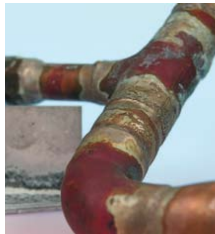
Flussmittelreste der Typ FH 10 und FL 20 auf Messing/Kupfer und Aluminium
